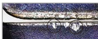
Nuance conventionnelle : Fissuration thermique
