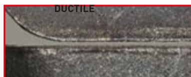
Arête de coupe résistant à l'usure en usinage de fonte ductile
